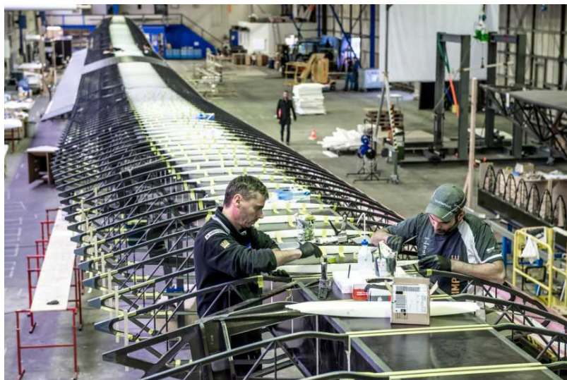
Установка солнечных батарей (solarimpulse.com)
