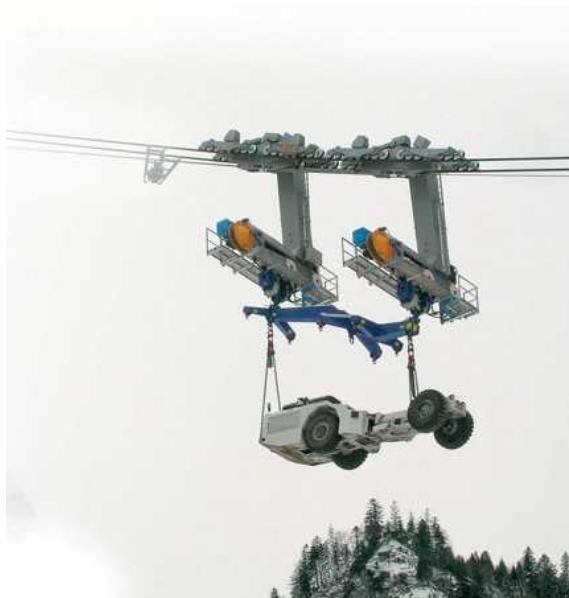
По канатной дороге поднимается самосвал ([mining-media.ru](http://mining-media.ru))
